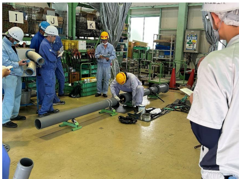
接合指導員による接合実演 (直管受口と直管挿し口の接合)
