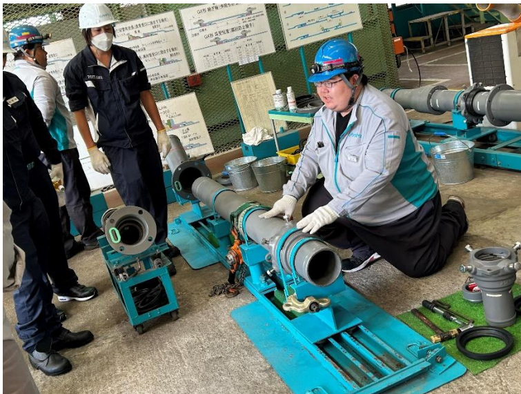
接合指導員による説明 (P-Link の取り付けについて)
