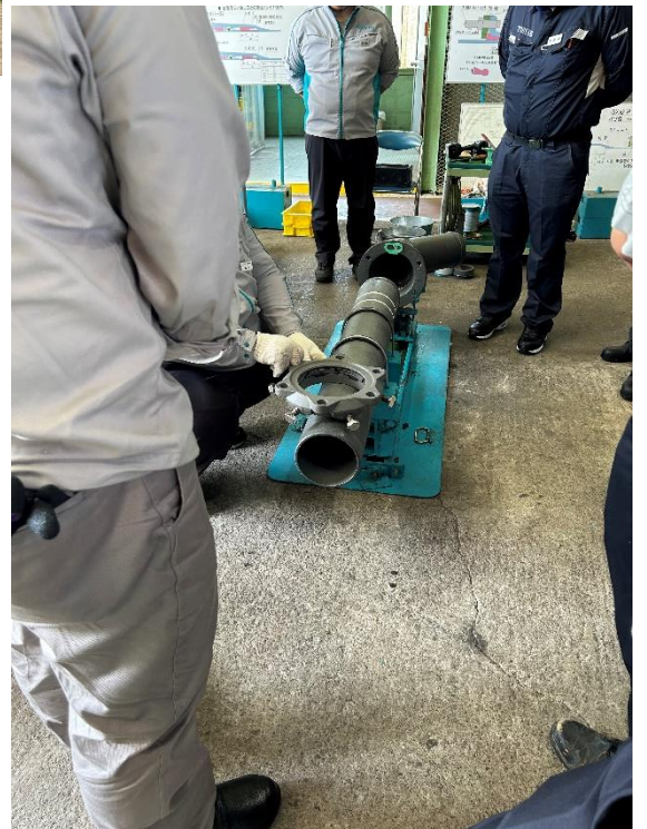
接合指導員による説明 (G-Link の取り付けについて)
